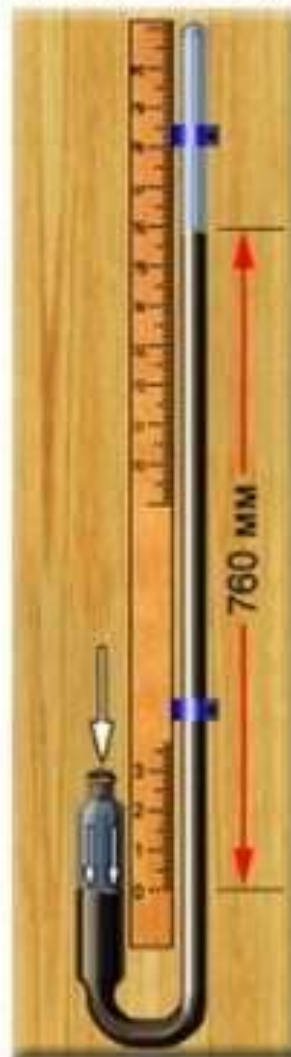
СХЕМАТИЧЕСКОЕ УСТРОЙСТВО РТУТНОГО БАРОМЕТРА
