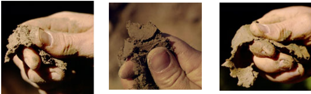
Рис. 5.2. Метод “стрічки” для визначення механічного складу ґрунту.
