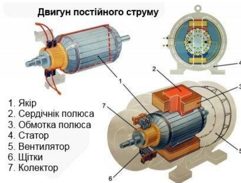
Рис. 3.2. Основні елементи двигуна постійного струму
