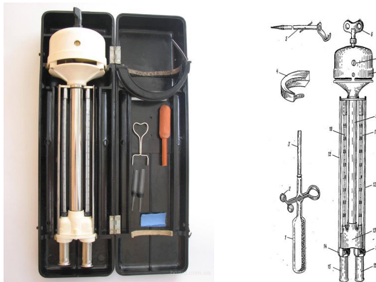
Рис. 5.2. Психрометр аспіраційний МВ-4М: зліва – загальний вигляд, справа – будова;
