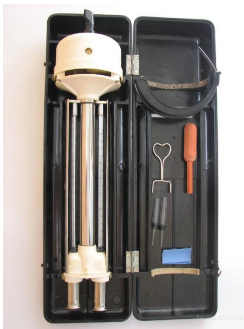
Рис. 5.2. Психрометр аспіраційний МВ-4М: зліва – загальний вигляд, справа – будова; 1 – гумова груша; 2 – затискач; 3 – піпетка; 4 – повітрязахист; 5 – крючок-підвіс; 6 – ключ, 7 – віконце; 8 – головка аспіратора; 9 – трубка; 10, 11 – “сухий” та “змочений” термометри; 12 – захисні планки; 13 – трійник;
