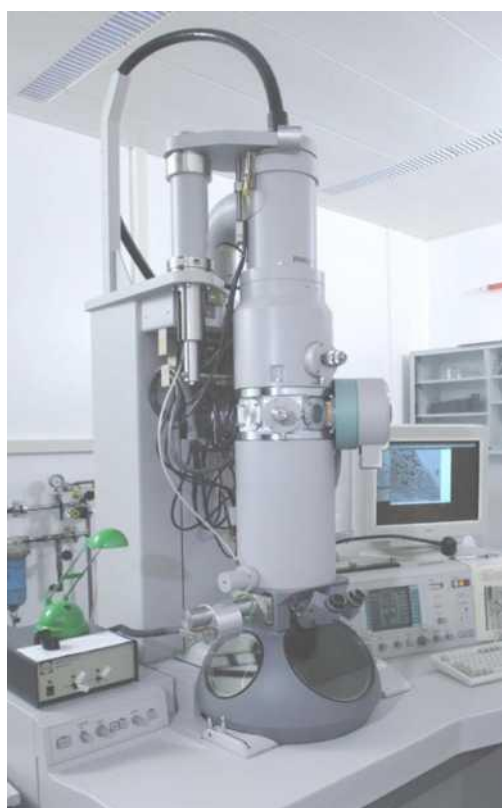
Рис. 2.7. Трансмісійний електронний мікроскоп і схематичне зображення потоку електронних променів
