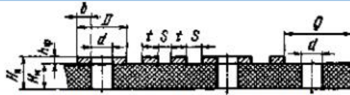
Рис. 1. Схема конструкції ОДП: H_n , H_m , h_\phi – товщини ДП, її підстави і фольги; b – гарантійний пасок; D , d – діаметри контактної площадки й отвору; S – відстань між краями сусідніх елементів провідного рисунку (ПР); t – ширина друкованого провідника; Q – відстань від краю плати, вирізу, паза до елементів ПР.
