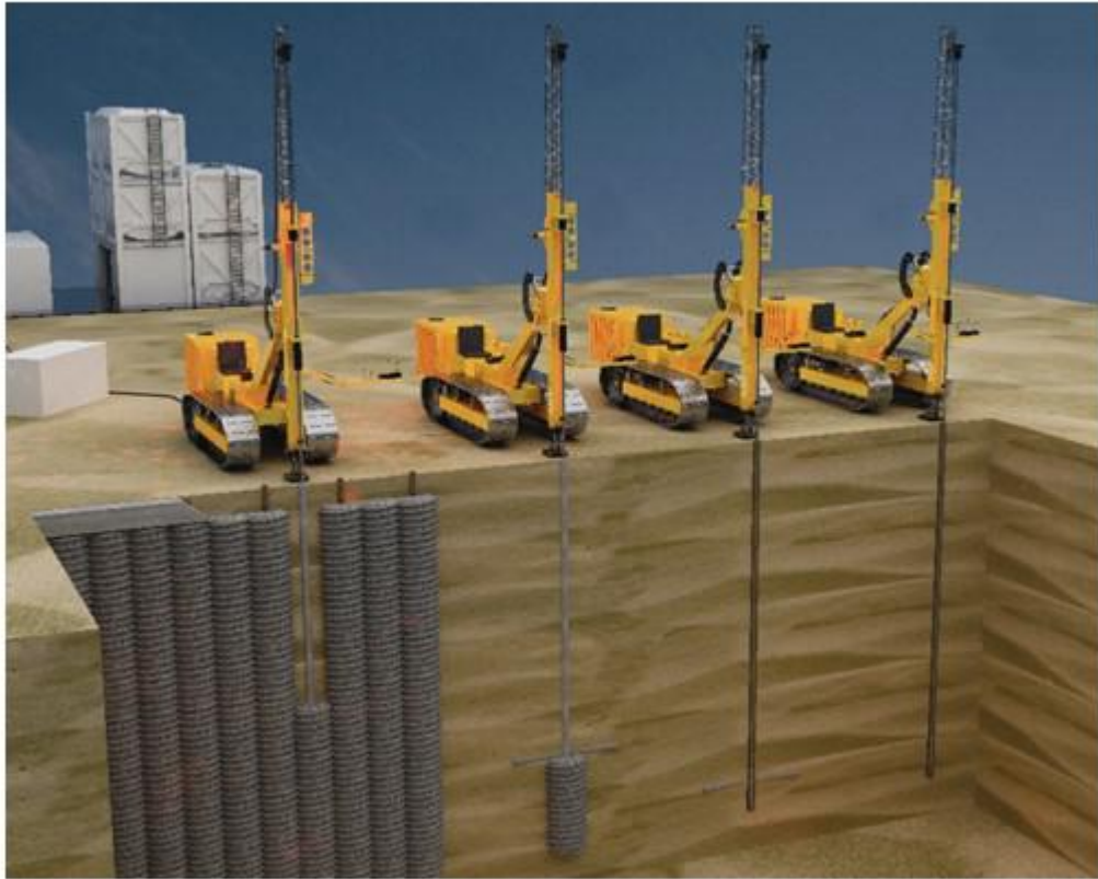
Рис. 5.17. Процес будівництва протифільтраційної завіси з ґрунтоцементних паль.
