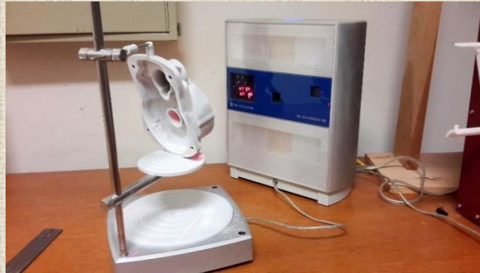
3D-сканер NextEngine 3D Scanner HD 3D-роздільна здатність - від 150 dpi до 400 dpi. Точність: 0,127 - 0,381 мм
