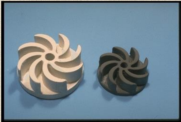
Структурна частина глинозему до і після спікання
