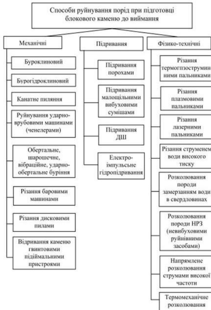
Рис. 14.3. Класифікація способів руйнування природного облицьовувального каменю при підготовці його до виймання
