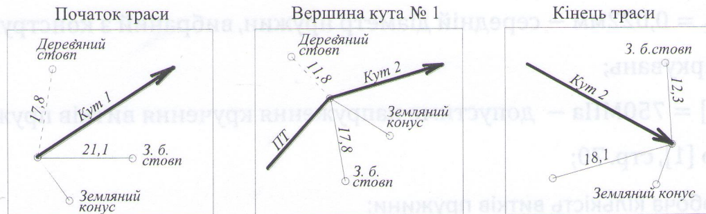
Рисунок 2.5 – Схеми закріплення основних елементів траси
