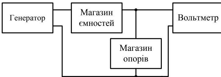
Рисунок 7.6 – Схема для вимірювання параметрів кореляції напруги та частоти для диференціюючої ланки
