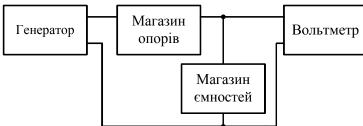
Рисунок 7.7 – Схема для вимірювання параметрів кореляції напруги та частоти для інтегруючої ланки
