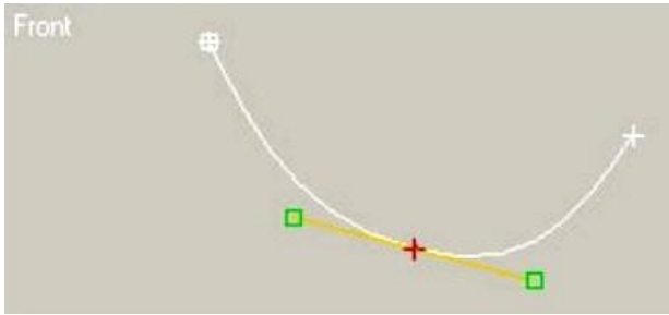
Рисунок 2.5 - Приклад Кривої Безьє у вікні САПР під час моделювання
