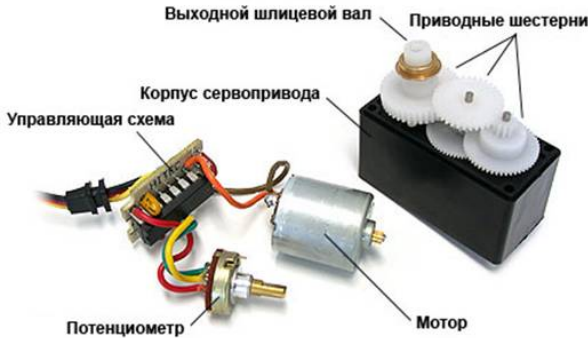
Рисунок 6.2 – Конструкція сервоприводу
