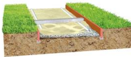
Рис.24. Приклад облаштованого шару підсипки
