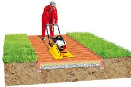
Рис.26. Процес ущільнення поверхні
