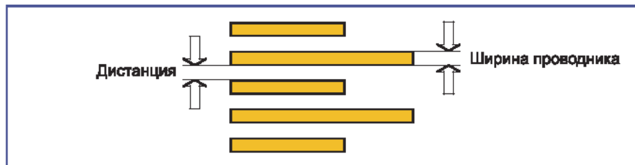
Рисунок 4. Формирование контактных площадки для установки микросхем
