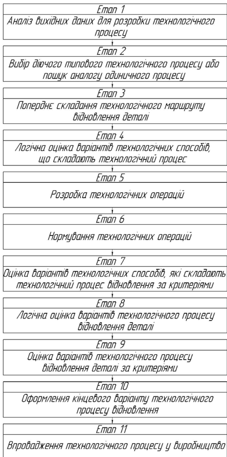
Рис. 8.1. Основні етапи проектування технологічного процесу відновлення
