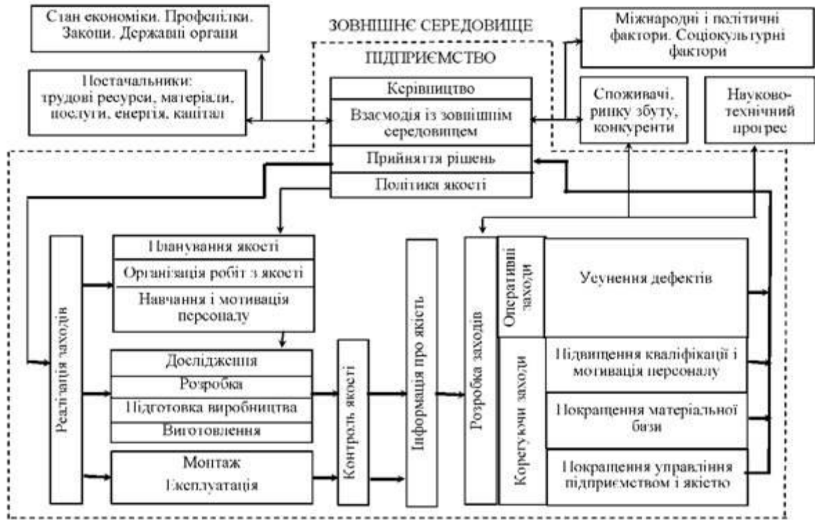
Рис. 4. Функціональна схема управління якістю продукції ("петля якості")
