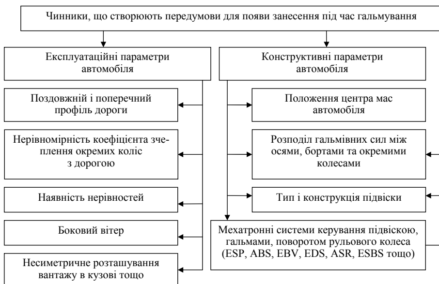
Рис. 7.43. Експлуатаційні та конструктивні чинники, що забезпечують стійкість автомобіля
