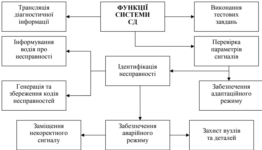
Рис. 7.11. Функції бортової системи самодіагностики
