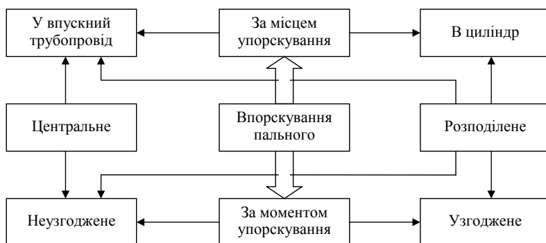
Рис. 7.51. Класифікація способів упрскування пального
