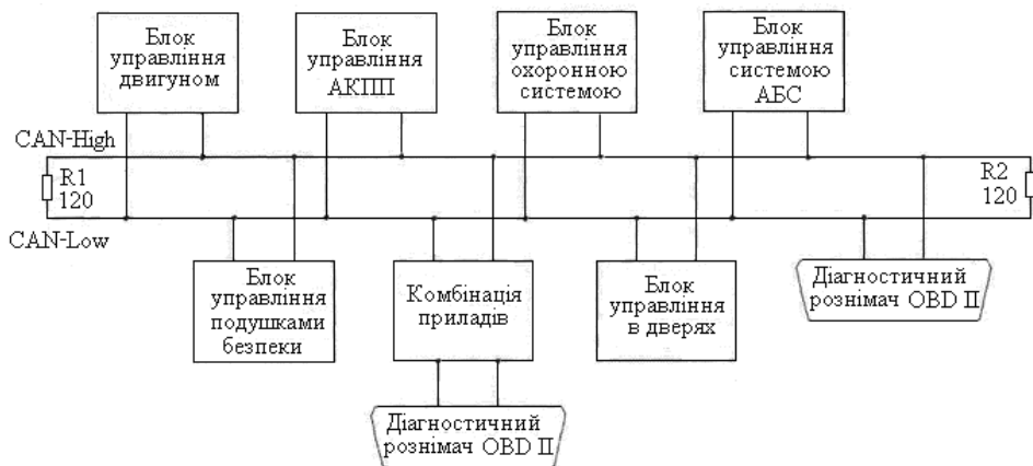
Рис. 7.3. Типова схема шини CAN
