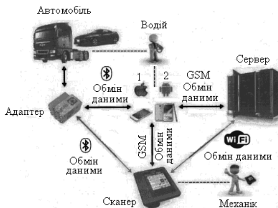
Рис. 7.20. Дистанційна комп'ютерна діагностика автомобіля:
