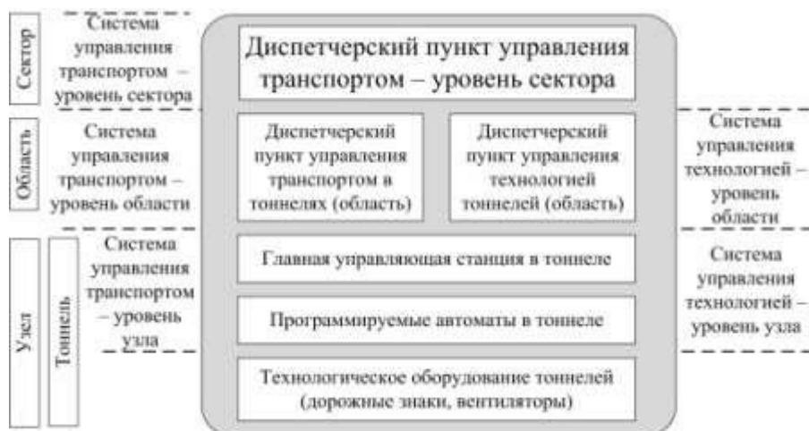
Мал. 2.10. Шари системи управління тунелем
