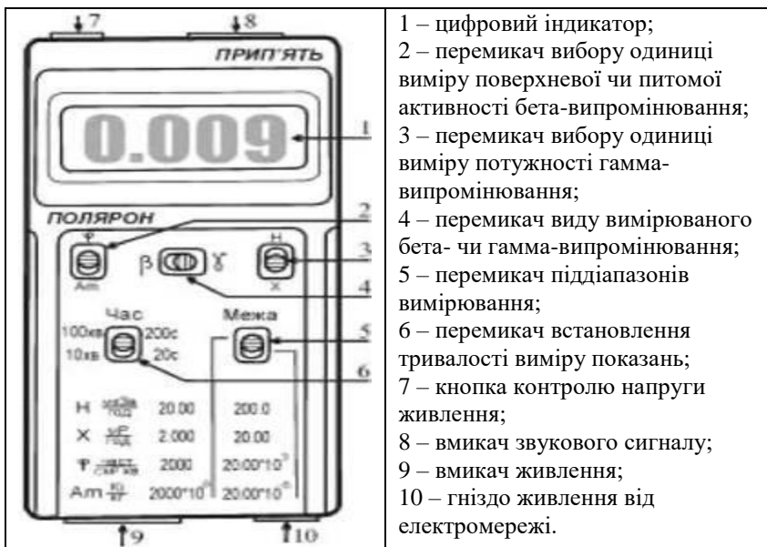
Рис. 8.2. Складові дозиметра бета-, гамма-випромінювання "Прип'ять".
