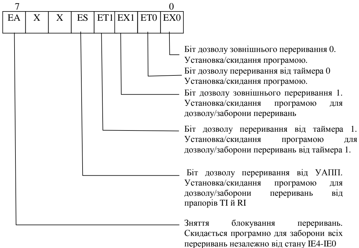
Рисунок 5.10 – Призначення бітів регістра дозволу переривань (ІЕ)
