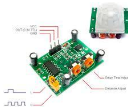
Рисунок 5.1 – Зовнішній вигляд датчика руху (присутності) HC-SR501
