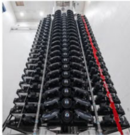
Рисунок 1 – Супутники Starlink у стартовому контейнері
