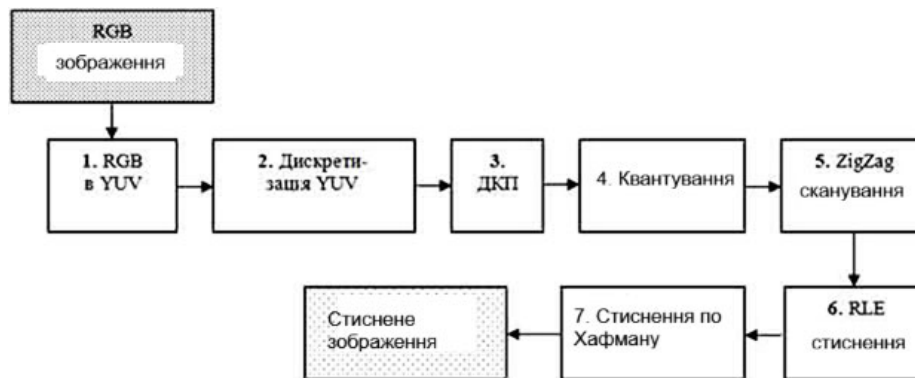
Рис. 1 Основні етапи процедури стиснення за стандартом JPEG
