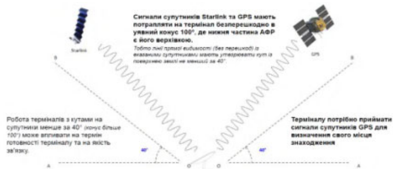
Рисунок 5 – Встановлення з’єднання між терміналом Starlink і космічним сегментом системи
