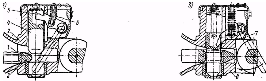
Рис.3.Напівавтоматичний тягово-зчіпний пристрій: а-положення затвора перед зчіпкою; б-положення затвора після зчіпки
