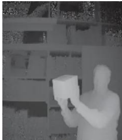
Рисунок 12 – Приклад мапи глибини з градієнтом сірого
