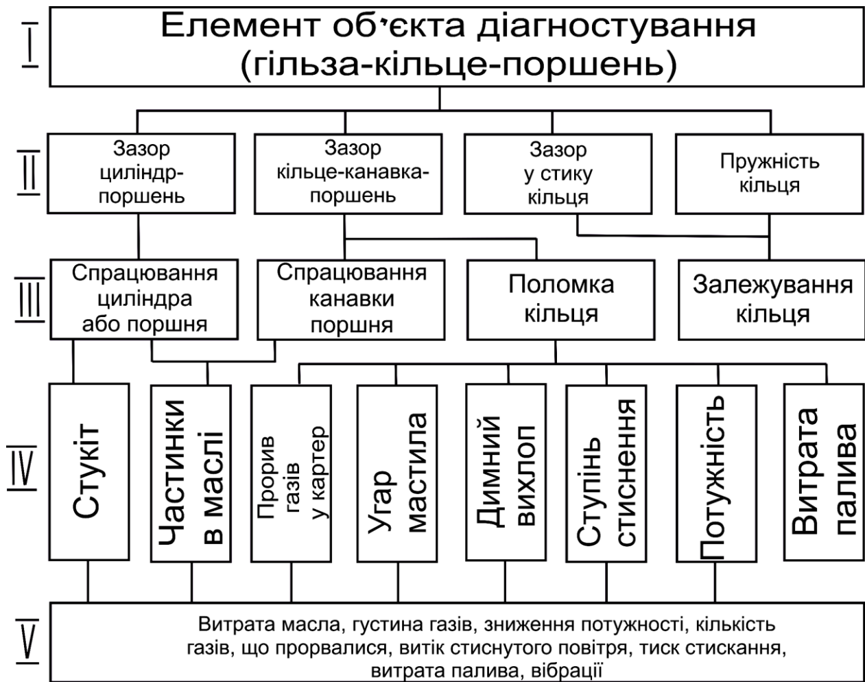
Рис. 2.1. Структурно-наслідкова діагностична модель
