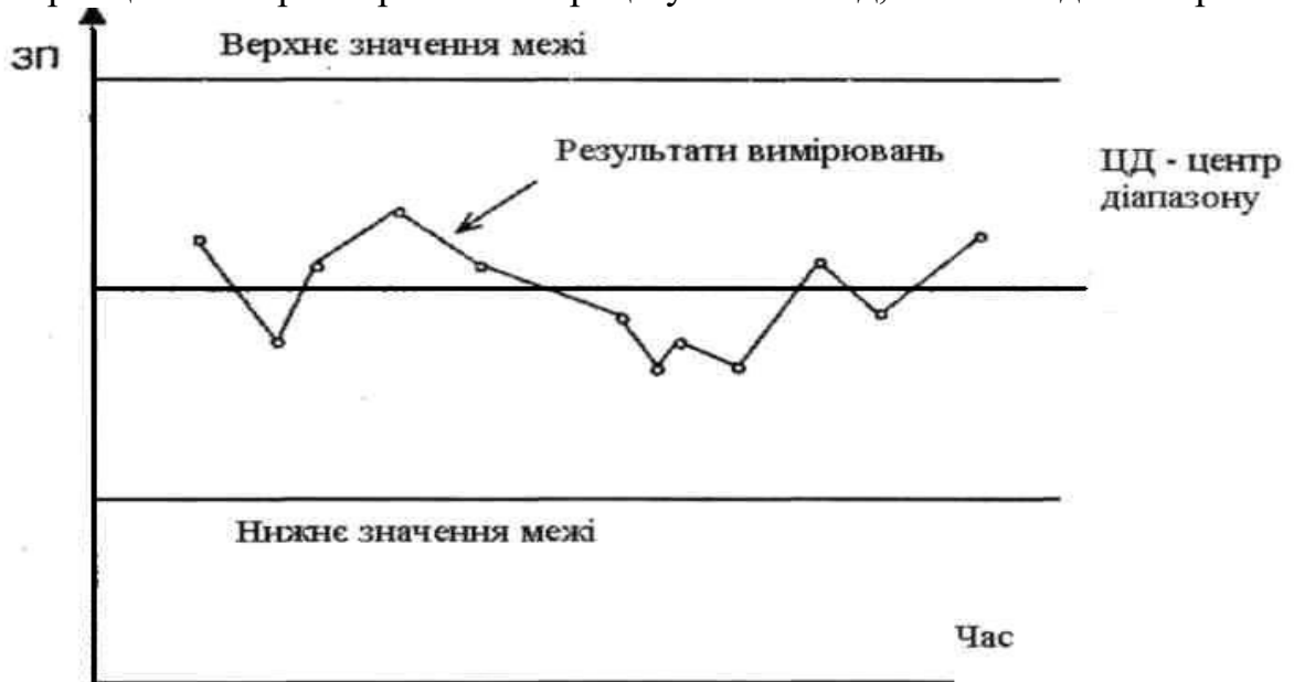
Рис. 6.5. Контрольна карта керованості процесу: ЗП – значення контрольованого параметра; ЦД – центр діапазону
