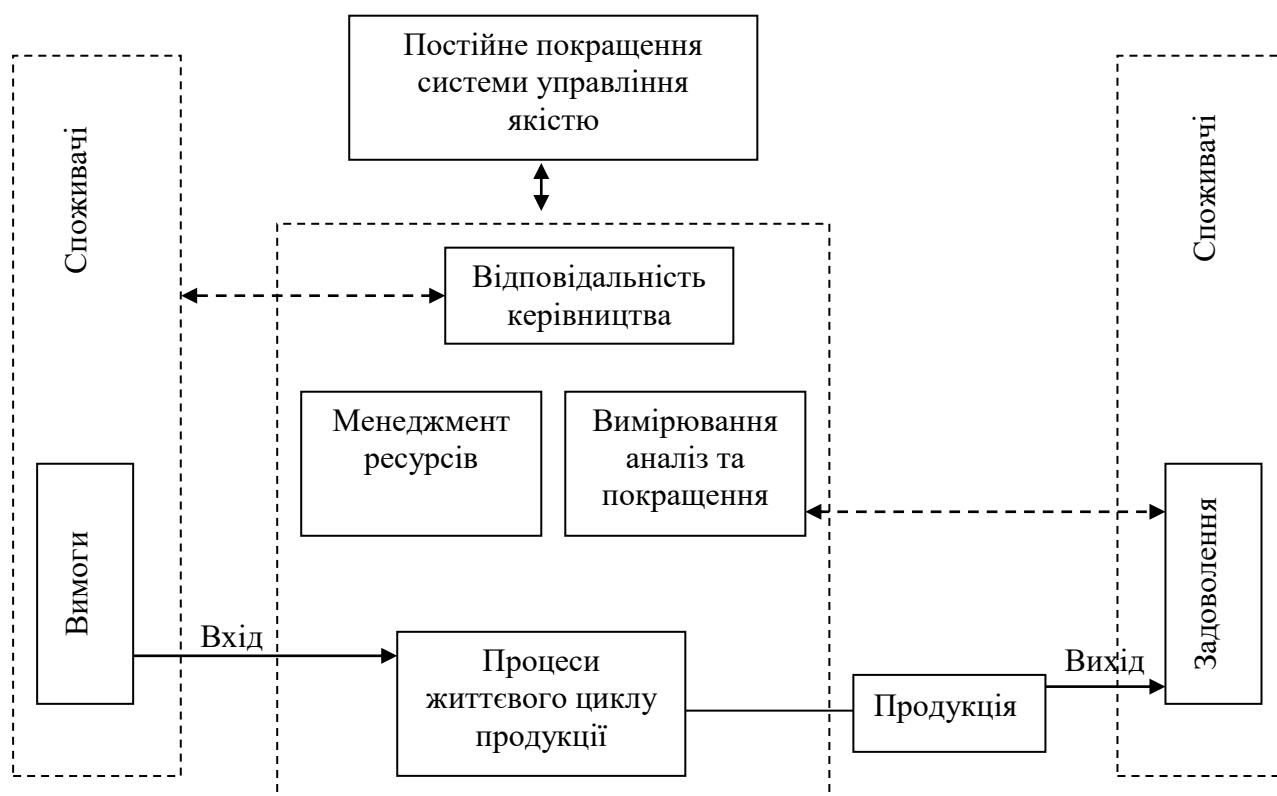
Рис. 5.1. Модель системи управління якістю, заснована на процесному підході
