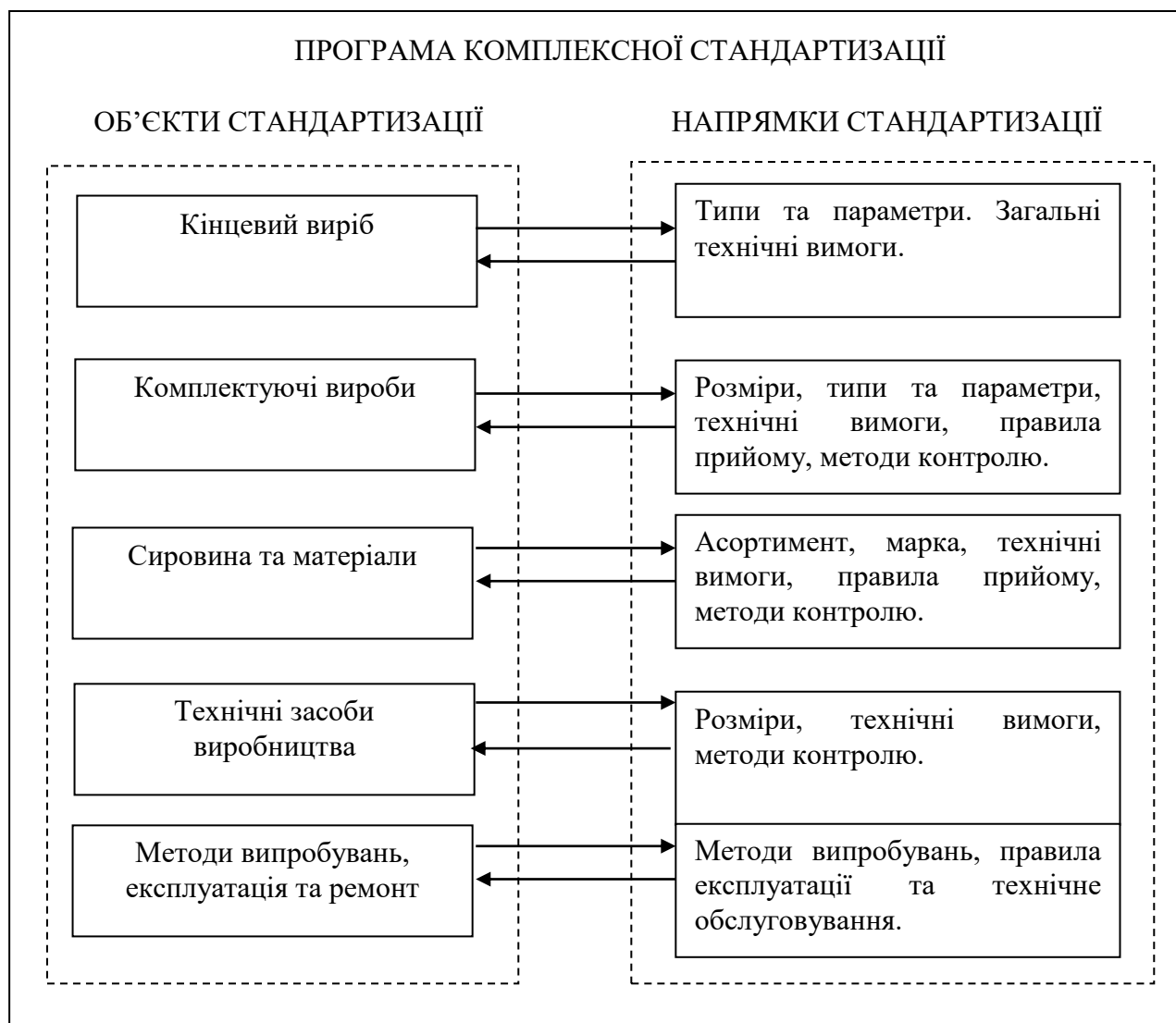
Рис. 1.2. Реалізація програми комплексної стандартизації на прикладі розроблення і виготовлення продукції машинобудування
