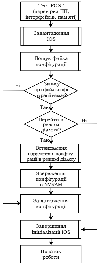
Рис. 16. Блок-схема спрощеного алгоритму завантаження комутатора Cisco Команди базового налагодження керованого комутатора Cisco
