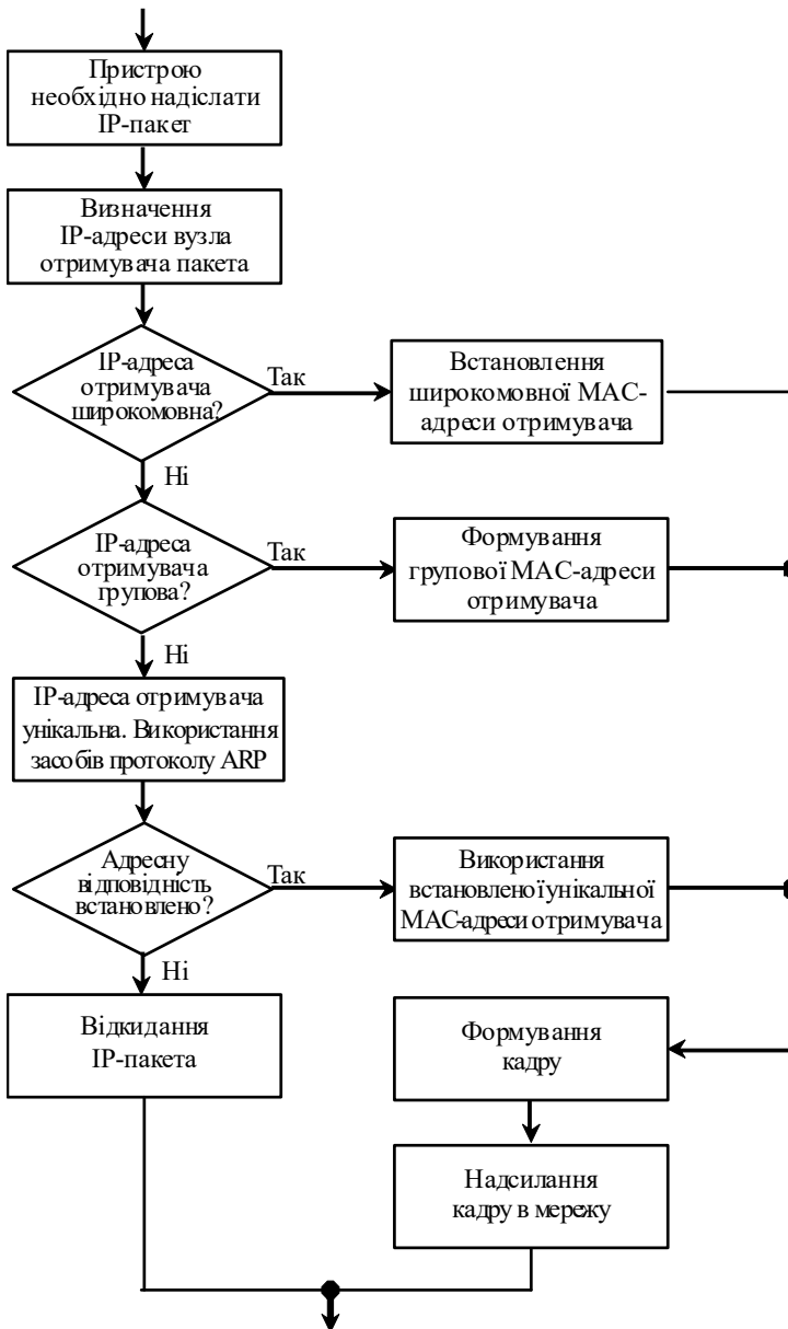
Рис. 1. Блок-схема узагальненого алгоритму застосування правил та протоколів установлення відповідностей між IP-адресами версії 4 та MAC-адресами
