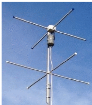
Рис. 1.46 – Зовнішній вигляд антени станції НСПП-137
