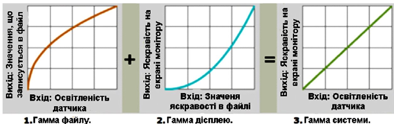
Рис. 2.6 – Процес гама-корекції в процесі візуалізації зображення на моніторі
