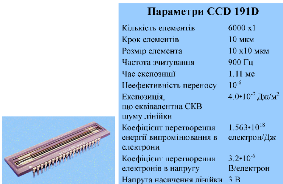
Рис. 1.32 – Зовнішній вигляд ПЗЗ- лінійки CCD 191D та її параметри
