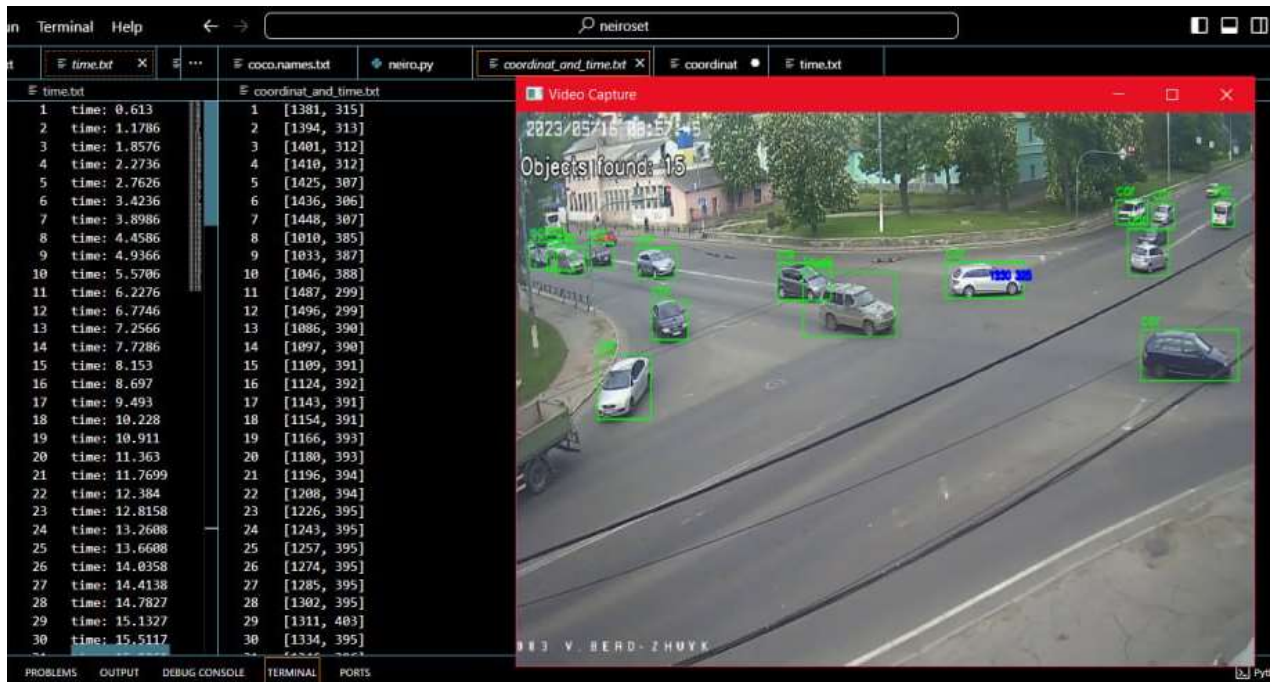
Рисунок 2.5. Кадр з відеопослідовності з визначеними класами об'єктів (авто, «саг») на зображенні, визначеними координатами центру мас та часу
