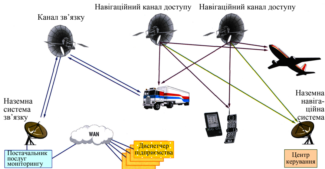
Рисунок 12.2 – Принцип дії супутникової навігації
