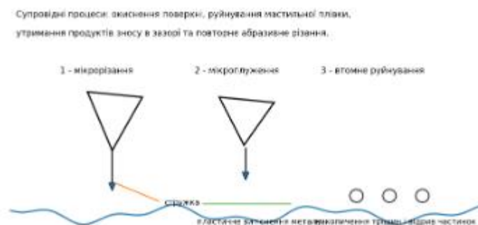
Рис. 2. Основні мікромеханізми абразивного руйнування поверхні пальця.
