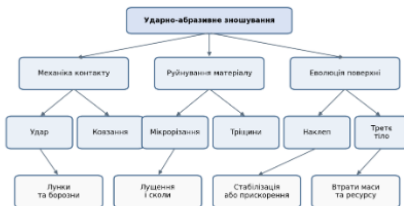
Рис. 2. Структурна схема процесу та наслідків ударно-абразивного зношування.
