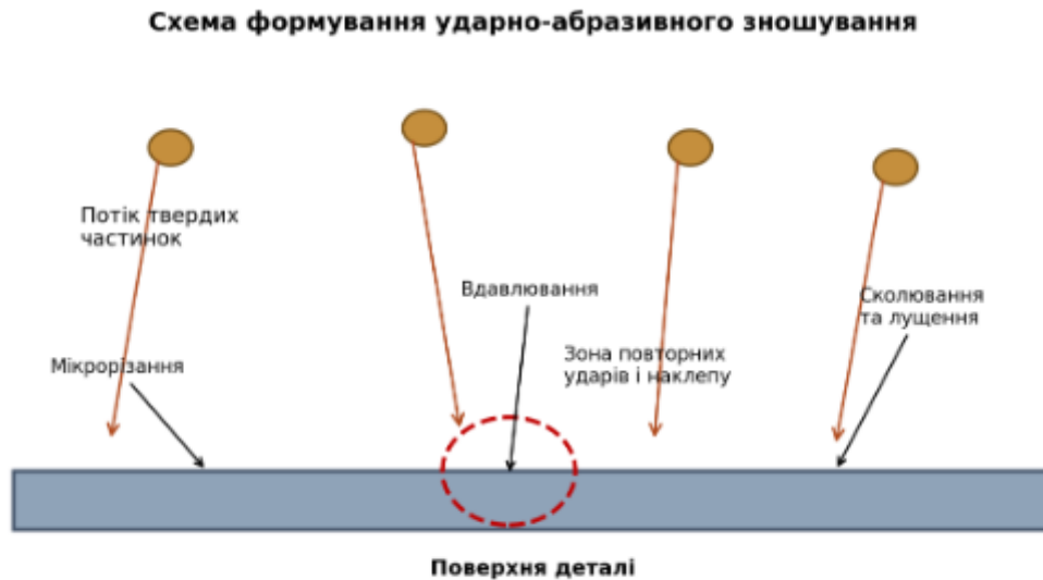
Рис. 1. Схема формування ударно-абразивного зношування.
