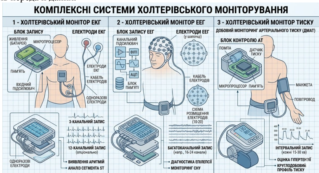
Рисунок 1 – Будова приладів для холтерівського монітування
