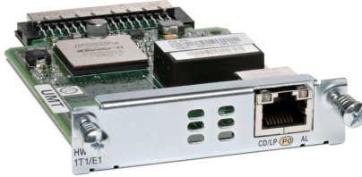
б) Cisco HWIC-1T1/E1 (последовний інтерфейс, рознім RJ-48)
