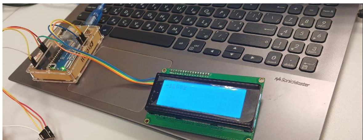
Рис.5.7 Підключення дисплею і гіроскопа до Arduino UNO
