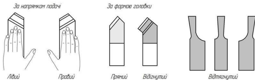
Рис. 1.3. Класифікація різців за напрямком подачі та формою головки різця
