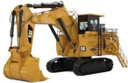
Рис. 3.14. Гідравлічний екскаватор з робочим обладнанням прямої (а) і зворотної (б) лопати
