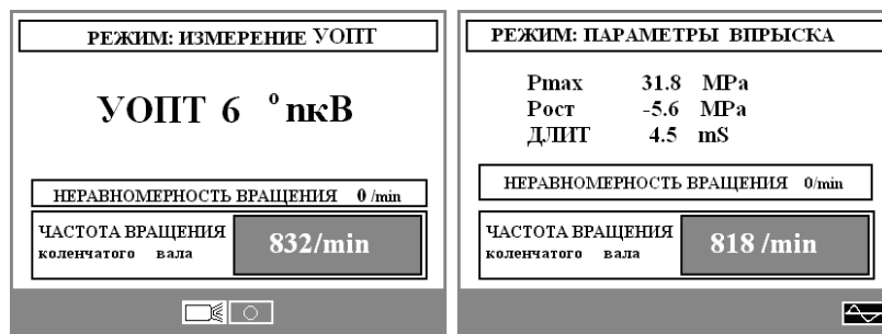
Рисунок 18.7 – Зображення на екрані мотор-тестера при діагностуванні паливної апаратури
