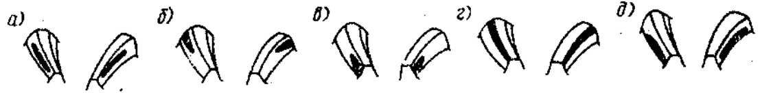
Рисунок 22.2 – Зсув плями контакту на зубах веденої шестерні головної передачі
