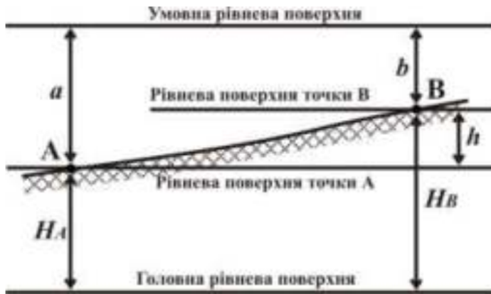
Рис. 48. Принципова схема геометричного нівелювання
