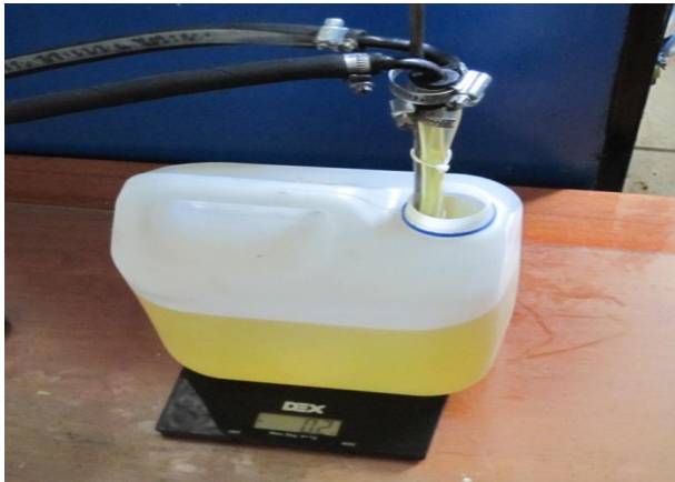
Рис.8. Система для визначення витрати палива ваговим методом
