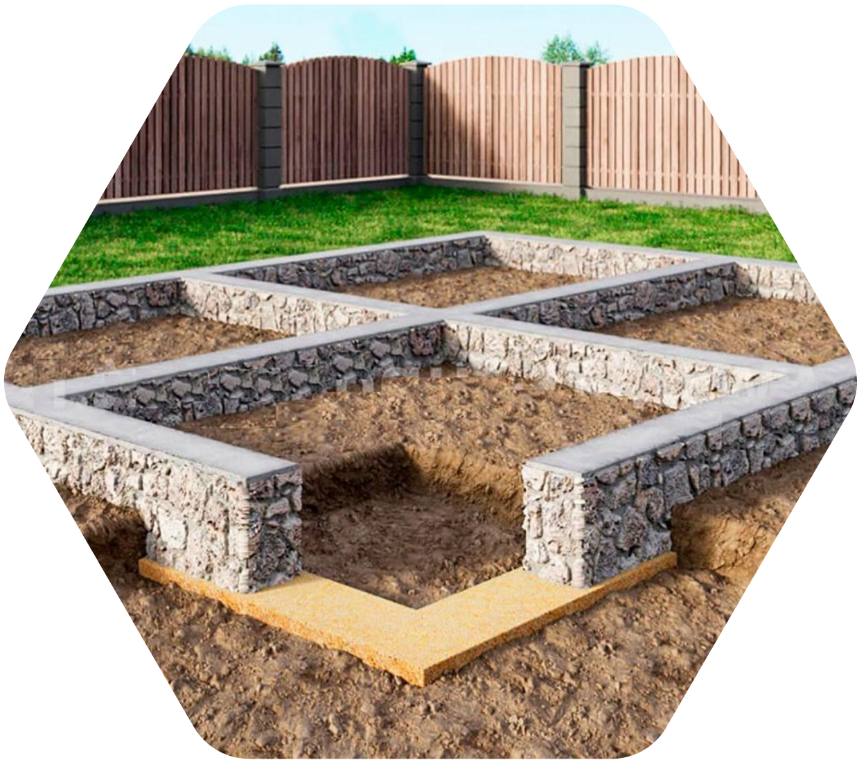
Стрічковий фундамент. Даний тип фундаменту являє собою безперервну стіну, рівномірно навантажену вище розташованими несучими, або самонесучими елементами будівлі.
