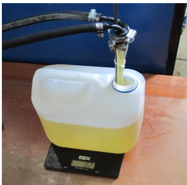
Рис.4. Система для визначення витрати палива ваговим методом
