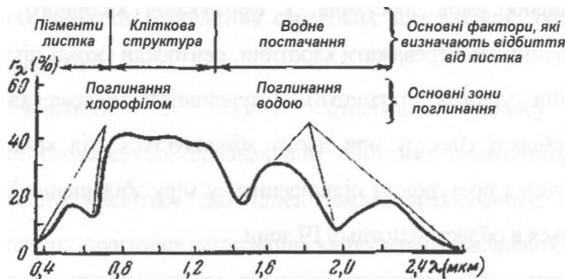
Мал. 3.4. Крива коефіцієнтів спектральної яскравості залежно від інтенсивності поглинання радіації хлорофілом
