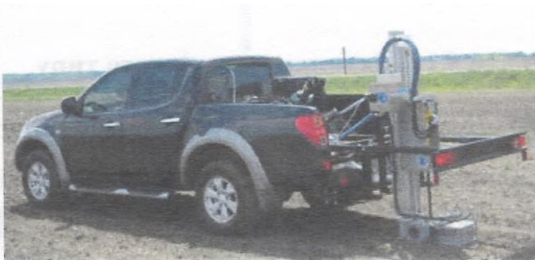
Мал. 6.5. Автоматизовані пробовідбірники зразків ґрунту а) Amity A2450, б) Duorob 60
