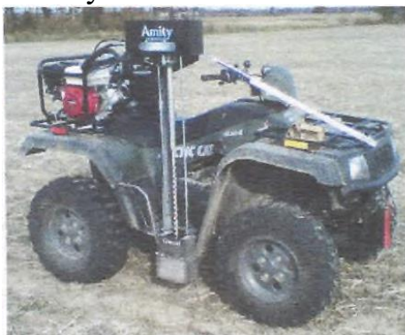
Мал. 6.5. Автоматизовані пробовідбірники зразків ґрунту а) Amity A2450, б) Duorob 60
