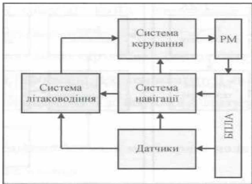
Мал. 4.2. Функціональна схема керування автоматичним режимом польоту.
