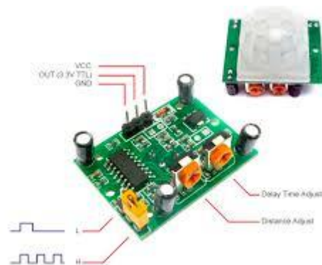
Рисунок 5.1 – Зовнішній вигляд датчика руху (присутності) HC-SR501
