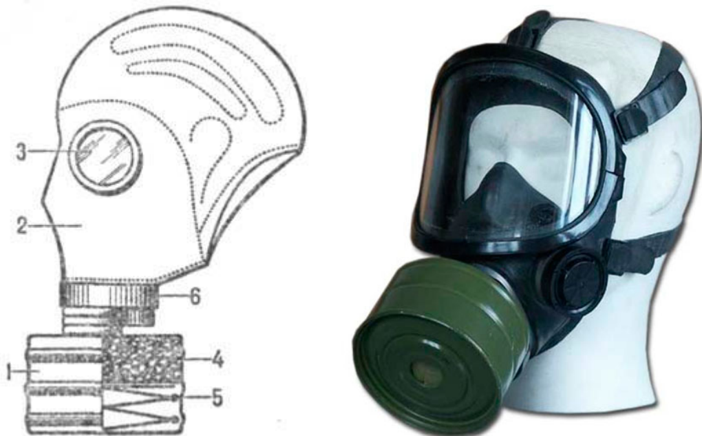
Рис. 2. Фільтруючий протигаз. 1-фільтруюча поглинальна коробка; 2 - лицьова частина .; 3 - очковий вузол; 4-шихта; 5-ПАФ; 6-клапанна коробка.
