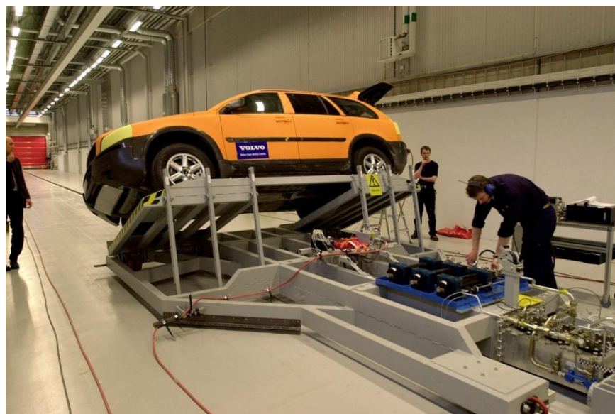
Рис. 5.11. - Випробування автомобіля на статичну стійкість
