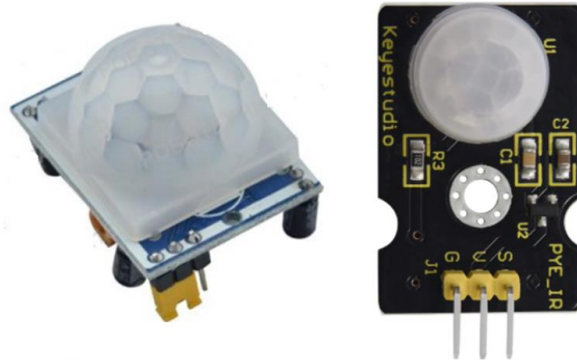
Рис. 2.5 - Типовий PIR-датчик з лінзою Френеля
