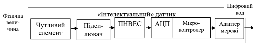
Рис.2.3 - Будова цифрового «інтелектуального» датчика
