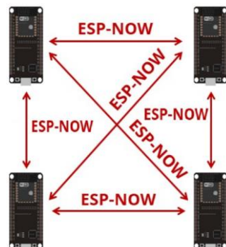
Рис. 5.15 - Відправлення даних по структурі «multiple -master-multiple-slaves»
