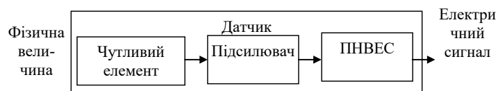
Рис.2.2 - Будова найпростішого датчика
