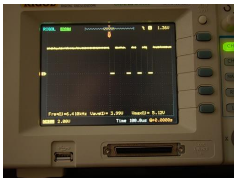
Рис.4.11 – Сигнал UART на екрані осцилографа.
