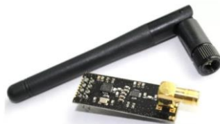
Рис. 5.11 - NRF24L01 з підсилювачем і зовнішньою антеною
